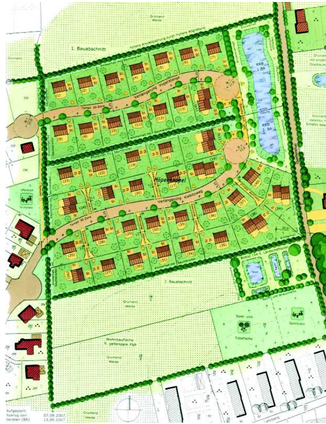
Abb. 18 „Städtebauliche Konzeption - Variante 1“ im Rahmen der Planüberlegungen zur 1. Änd. und Erg. des B-Planes Nr. 28 mit Regenrückhaltebecken innerhalb des Plangebietes und überwiegend größeren Wohnbaugrundstücken (Stand vom 21.09.2007)
